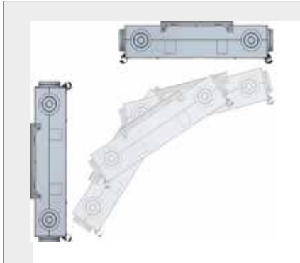
Dos posibilidades de instalación: horizontal o vertical para facilitar el armado del sistema
